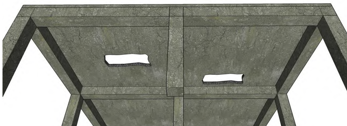
Σχήμα 6-34. Άνοιγμα τρύπας κοντά στο δοκάρι (δεξιά) και όχι στο κέντρο της πλάκας (αριστερά).
