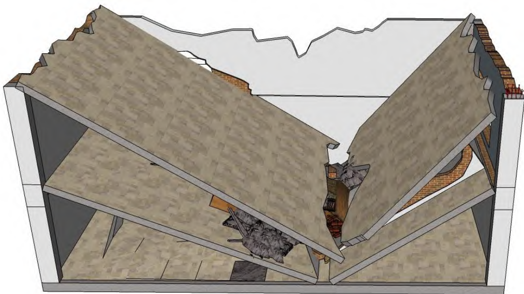
Σχήμα 7-1. Κατάρρευση τύπου V.
